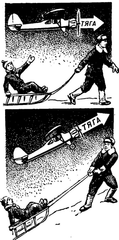
Рис. 7. Подобно санкам, самолет нуждается в тяге. При подъеме она должна быть больше, чем при горизонтальном полете.
