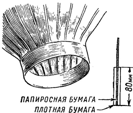
Рис. 26. Выклеивание кольца для горловины шара.
